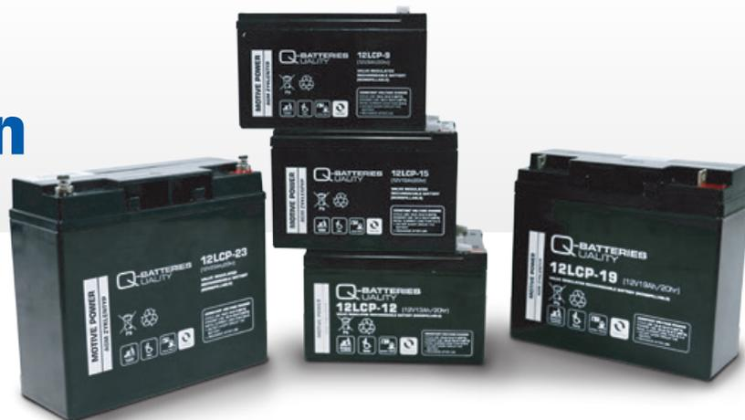
Bei dem Q-Batteries-Akku der Serien 12LC und 12LCP handelt es sich um AGM-Akkus (Blei-Vlies-Technologie), die speziell für den zyklischen Einsatz konzipiert wurden. Durch den Einsatz spezieller Blei-Platten und der Verwendung eines besonderen Elektrolyts, weisen die Akkus eine höhere Lebensdauer und Zyklenfestigkeit auf.
